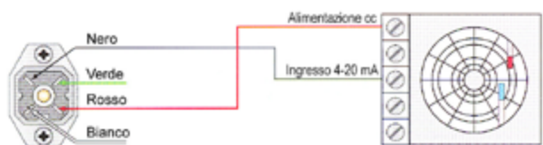
SCHEMA 1: 4-20 mA, loop alimentato dal ricevitore
